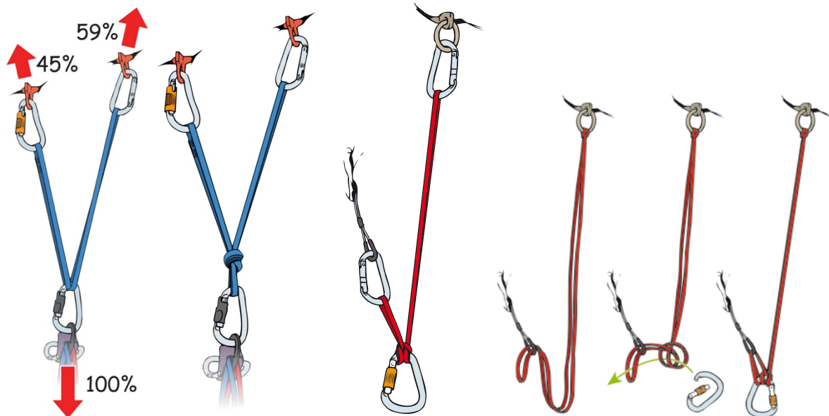
Abb. 9: v.l.n.r.: altes Kräftedreieck (= Ausgleichsverankerung - nicht mehr aktuell!), fixiertes Kräftedreieck mit Sackstichauge, fixiertes K3 mit Mastwurf und Karabiner als ZP, Südtiroler Kräfteverteilung
